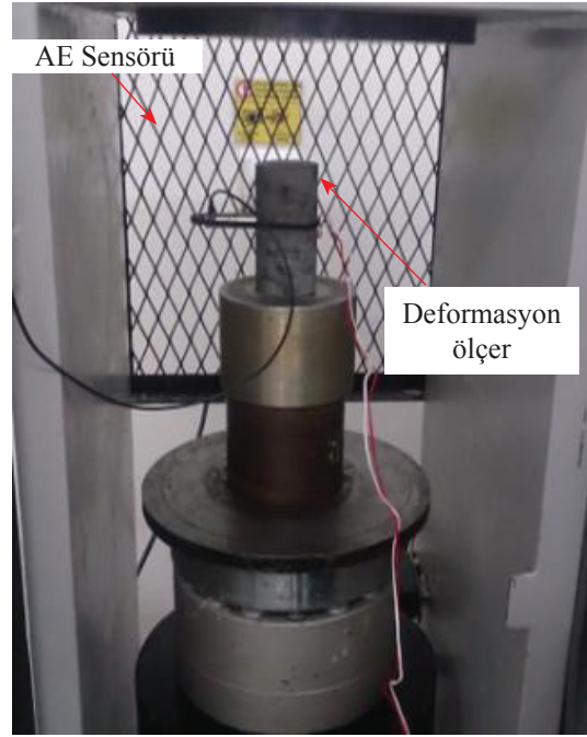
Şekil 4. Gerilme artışına bağlı olarak gelişen kHz mertebesindeki tüm titreşimleri algılayan sensör ve aynı zamanda karota yapılandırılmış olan deformasyon ölçerlerin görünümü.
