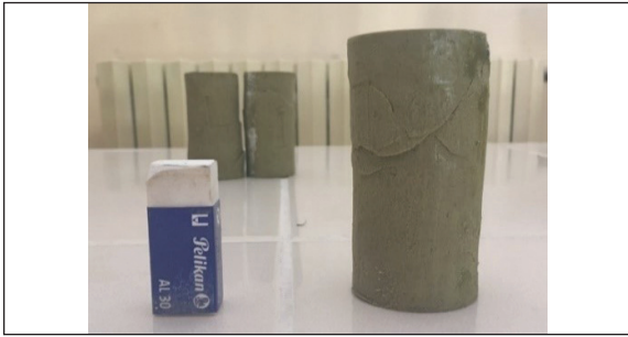
Şekil 3. UCS deneyi gerçekleştirilen numuneler.
